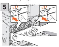
Empuje la caja de residuo de tóner hasta que las lengüetas superiores hagan clic. Cierre la cubierta frontal presionando ambos bordes.
