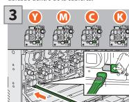
Inserte el limpiador a través del orificio de servicio de la unidad de revelado hasta llegar al fondo.
