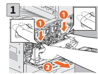
Abra la cubierta frontal, coloque los dedos en las ranuras frontales de la caja de residuo de tóner, y tire mientras empuja la lengüeta superior hacia abajo.
