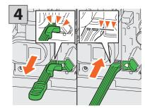
Coloque los dedos en las ranuras frontales de la caja de residuo de tóner y tire mientras empuja la lengüeta superior hacia abajo. Luego, limpie los cabezales de impresión LED. Para obtener instrucciones sobre cómo limpiar los cabezales de impresión LED, consulte la página siguiente:
